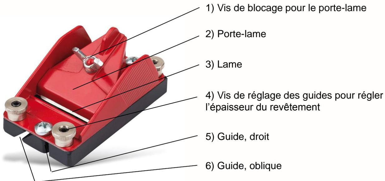
Des mouvements de va-et-vient du support de lame (2) desserré permettent de régler la lame (3) à la profondeur de coupe souhaitée.
